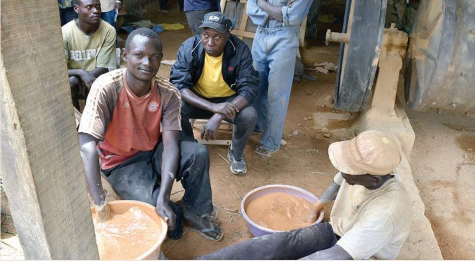
Des orpailleurs artisanaux procèdent à l'extraction de l'or en mélangeant le minerai avec du mercure et de l'eau
